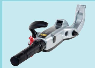
Die, als optionales Zubehör verfügbare, Multifunktionspinne für BFP60/BF60 enthält alles, was Sie brauchen: Servo-Trim-Kippschalter, reversibler Schalthebel, GriffhöhenEinstellung und Motorwarnanzeige.
